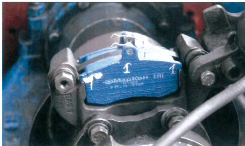
Рис. 2. Установка образцов № 1 и № 2 на стенде «НАМИ-СТН».
