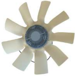
Вентилятор в сборе с муфтой вязкостной (715) 21-700
